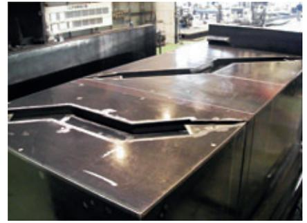
Abb. 5, 6 und 7: Schalsystem von Toyota ohne Zerlegung des Innenkerns
